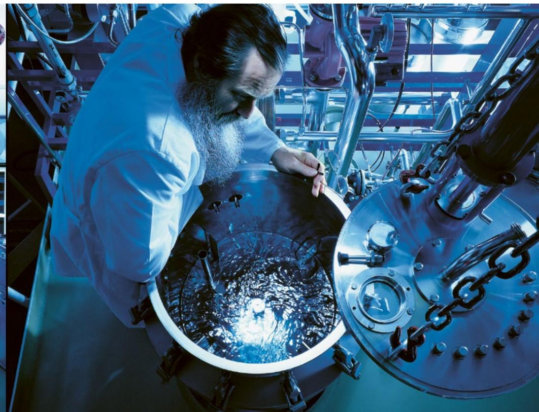
300l Bioengineering-Fermentationsanlage. Neben systematischen Untersuchungen zum Scale-up von Bioprozessen, die durch auf den vorangegangenen Seiten skizzierte Computersimulationen unterstützt werden, dienen diese Anlagen der Durchführung von Verfahren im halotechnischen Massstab, um beispielsweise Grundoperationen der Produktaufarbeitung, ebenfalls im halotechnischen Massstab, durchzuführen.
