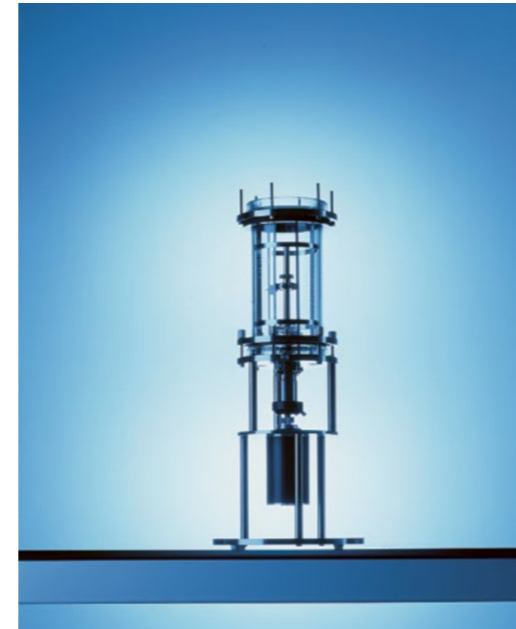
Das Glas wird mittels Klemmrings auf den Boden geklemmt.
